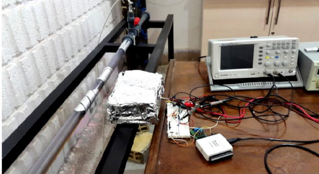
دستگاه حسگر اندازه گیری کسر حجمی گاز در لوله جریان دو فازی
